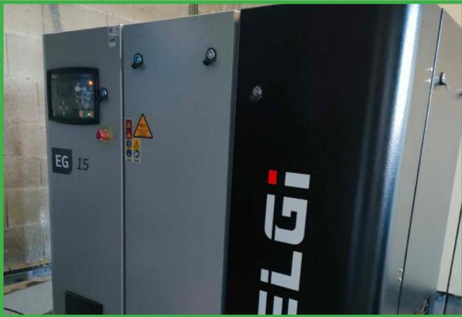
En 2023, nous avons remplacé notre ancien compresseur d'air devenu vétuste par **un nouveau compresseur d'air moins énergivore**. En effet, nous sommes passés d'une consommation de 22 kilowatts-heure à 15 kilowatts-heure. Ce nouvel outil plus moderne dispose de vitesses variables permettant ainsi d'effectuer des économies d'électricité non-négligeables. Cet investissement encourage notre dynamique vers le « **consommer mieux** » !
